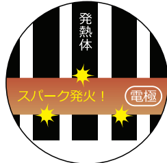
従来からのフィルムヒーターの構造
